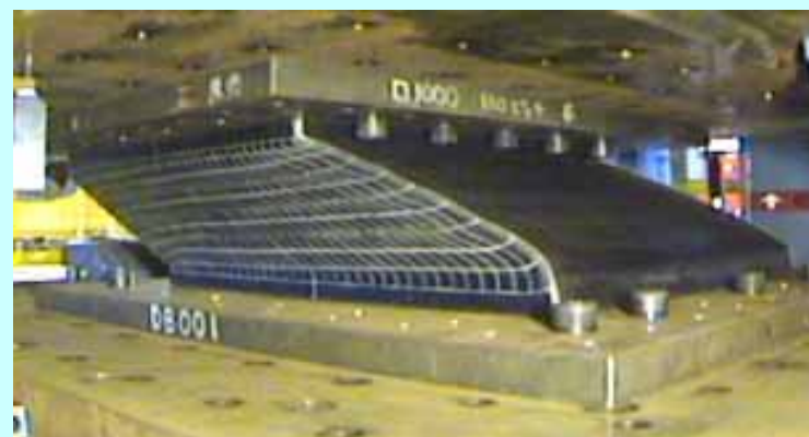
せん断変形性能試験
