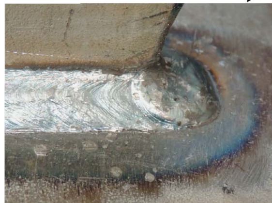
適切にまわして施工した例
