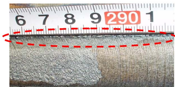
スラグ(ガス切断法)
