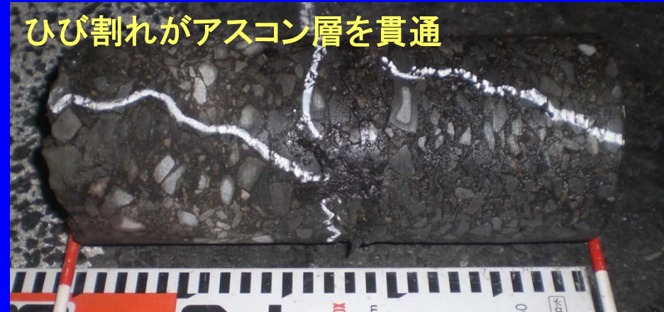
アスコン層内部の混合物自体の剥離が進行
