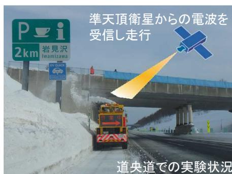
○除雪トラックのサイドシャッタ(雪を抱え込む装置)を自動開閉し、交差点での雪の排出を抑制 ※令和2年2月から公道上で運用
