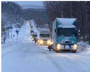
縦断勾配6%の区間で大型車の立ち往生が発生。冬用タイヤ(チェーン未装着)の後続大型車が複数台立ち往生し、3kmの滞留が発生
