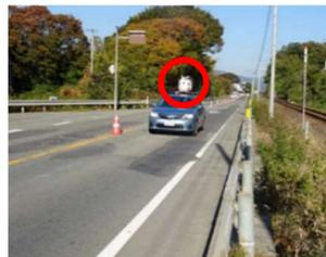
車載装置による路面性状測定
