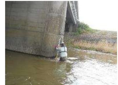
手作業による下部工洗掘状況の計測
