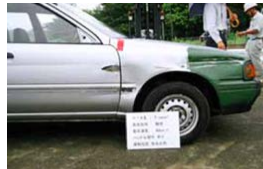
■実車実験により付着した金属片と 損傷した車両(継ぎ目部)
