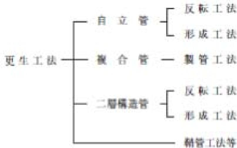
自立管：更生材単独で自立できるだけの強度を発揮させ、新設管と同等以上の耐荷能力および耐久性を有するもの。
