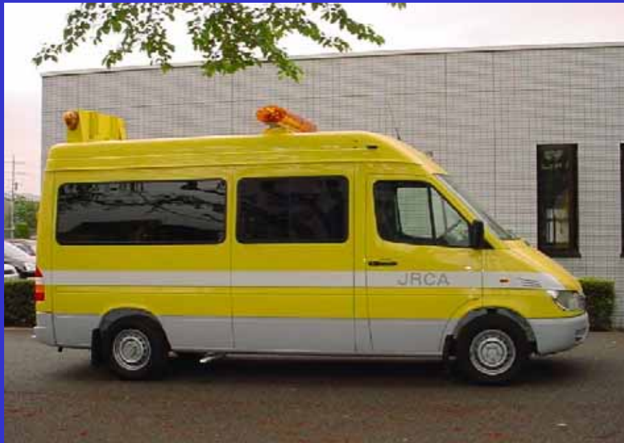
舗装路面騒音測定車
