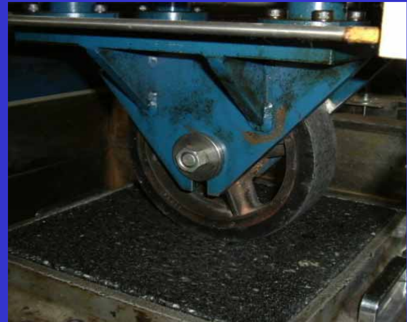
載荷走行試験状況
