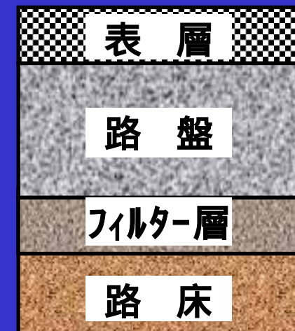
透水性舗装の構成
