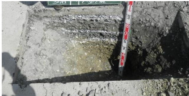
図 3-18 構造調査で確認する舗装の中身
